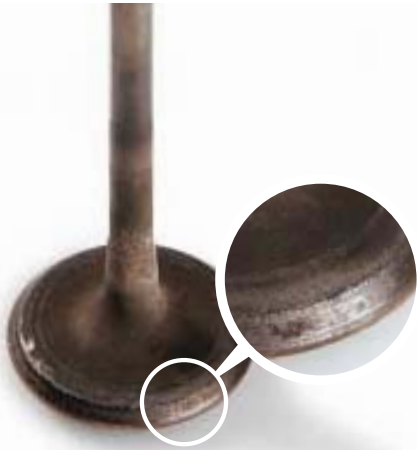
Die Sitze der Auslassventile zeigen deutliche, der hohen Laufleistung jedoch angemessene Brandspuren
