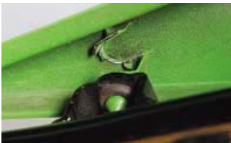
Ob auch die abgebrochenen Zapfen auf das Konto der Motor-Vibrationen gehen, ist nicht sicher
