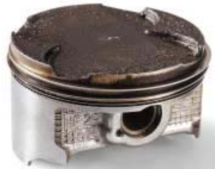
Das Laufbild der Kolben ist tadellos. Die Kolbenböden weisen jedoch eine starke Verkockung auf
