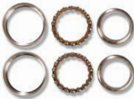
Das verschlissene Lenkropleger machte sich durch leichtes Einrasten unangenehm bemerkbar
