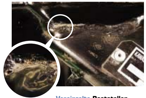
Vereinzelte Roststellen am Rahmen sprechen nicht für eine hochwertige Lackierung
