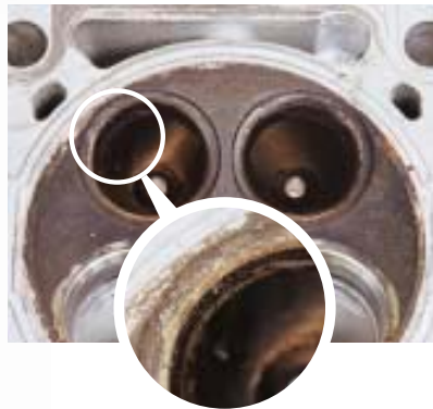
Die Ventilsitze der Auslassventile im Zylinderkopf haben leichte Brandspuren, waren aber dicht
